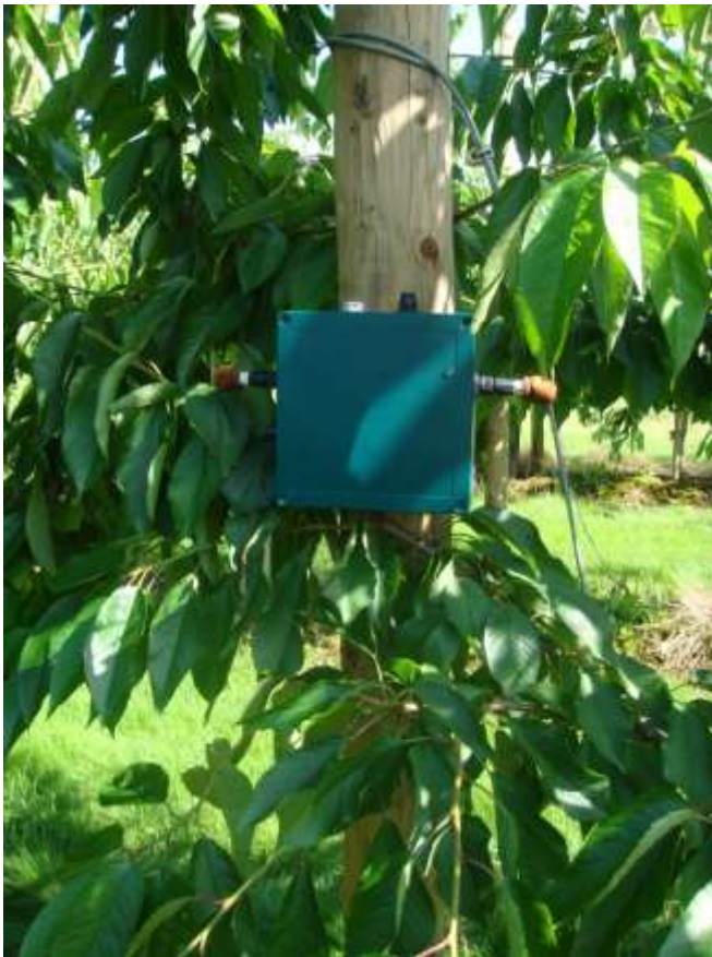
Abb. 7: (oben) Stereoaufzeichnungsgerät SM2. Fotos: Wildlife Acoustics. (links) Anbringung eines SM2 in einer Kirschuntersuchungsfläche
